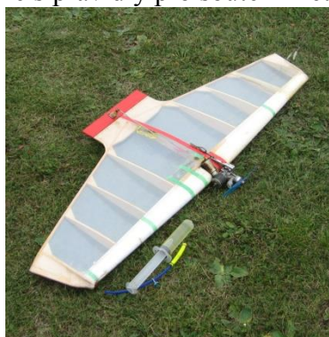
Nevypadá jako model letadla, je to samokřídlo se spalovacím motorem.
